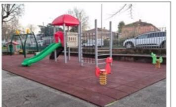
I lavori sono stati eseguiti al fine di avere un'area a norma di legge che garantisca la sicurezza dei bambini, seguendo principalmente le norme tecniche europee UNI EN 1176 (per le attrezzature) e UNI 1177 (per le pavimentazioni antitrauma), insieme alla normativa italiana UNI 11123 per la progettazione generale, che stabilisce requisiti stringenti di progettazione, installazione e manutenzione per prevenire infortuni, e prevede ispezioni periodiche e materiali sicuri e atossici.
